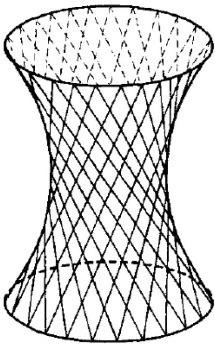
Sl. 11.5. Jednoplošni hiperboloid je pravčasta ploha. Time izričemo jednu neobičnu tvrdnju: čitava se ploha može dobiti kao unija pravaca! Možda najzorniji dokaz tome (uz žičane modele plohe koje je sve teže pronaći) je način izgradnje dimnjaka nuklearnih centrala koje većinom imaju oblik jednoplošnog hiperboloida, a okosnicu im čine ravni betonski blokovi. Gradnjom na taj način postiže se veća stabilnost konstrukcije nego, recimo, ako je ona cilindričnog oblika.
