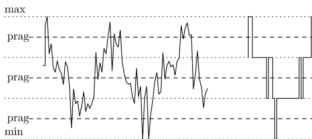
Slika 4.1.: Kontinuirani signal prije i nakon kvantizacije.
