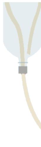
Punimo li vrč vodom on će se ponašati kao spojene posude. Voda će imati istu razinu u vrču i u cijevi ali neće istjecati. No kad se razina vode popne do luka savijene cijevi, prelit će se i istjecati sve dok posve ne isteče, odnosno dok se stupac tekućine ne prekine ulaskom mjehurića zraka u cijev. Pri istjecanju se voda diže sa niže razine u vrču na višu razinu u prelevnoj cijevi. Kad nastane prekid, istjecanje će stati.
